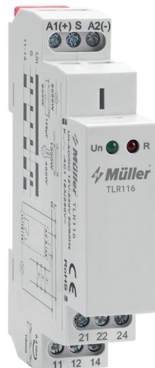
► **Aplicaciones:** Relé de enclavamiento, controlado por pulsadores desde varios lugares puede sustituir a los interruptores de tres vías o interruptores de barra transversal gracias al control por botones (número ilimitado, conectados en paralelo por 2 cables), la instalación se hace más transparente y más rápido para el montaje.
